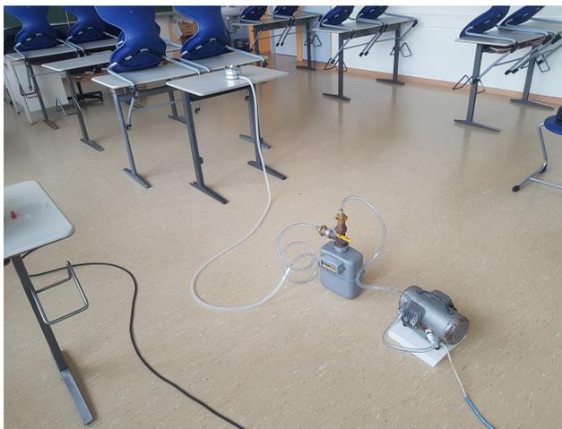
Nach dem Unterrichtsbetrieb erfolgt eine Luftkeimzahlbestimmung als aktives Impingement direkt auf den Nährböden. Dazu wird ein spezieller Keimsammler verwendet. Dieser besteht aus einer nach innen gerichteten Düse, durch welche die Luft bei Anlegen eines Vakuums hindurch gesogen wird. Dabei wird die Luft durch eine Lochmatrix gleichmäßig verteilt.
