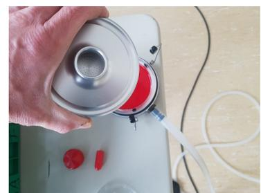
Danach wird die abgesaugte Luft durch einen Gaszähler geführt, um das Luftvolumen zu erfassen, welches über den Nährboden angereichert wurde.
