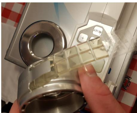
Zur Probenahme wird der in rechteckige Kavitätplatten eingebracht Nährboden in das Gerät eingespannt. Dazu wird der Nährboden in den Probenahmekopf eingeschoben.
